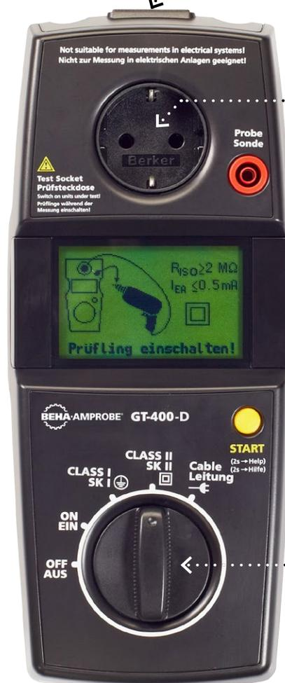
Testanschluss zum Anschließen von Testobjekten
