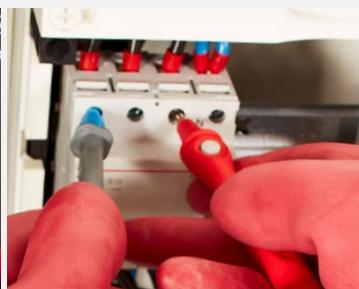
**Sonda de prueba con botón de prueba**
