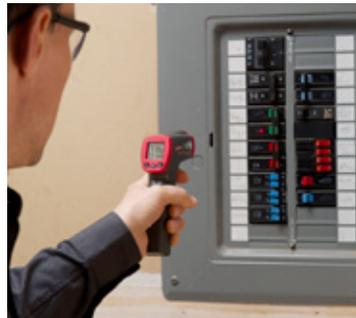
Il luminoso display LCD e il puntatore laser rosso rendono semplice verificare la temperatura di fusibili, isolamento, alloggiamenti di lampadine e molto altro, anche in aree scarsamente illuminate.
