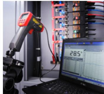
Il modello avanzato IR-750-EUR registra fino a 99 punti dati per minimo, massimo, media e hold, e dispone di una porta USB per esportare i dati per analisi dettagliate.
