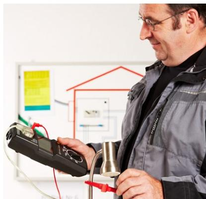
Séquence de test automatique pour les équipements en classe de protection I, classe de protection II/III.
