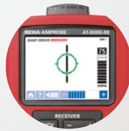
Der Smart Sensor™ zeigt an, dass er an der spannungsführenden Leitung ausgerichtet ist. Auf dem Bildschirm werden die genaue Position und Ausrichtung der Leitung angezeigt.
