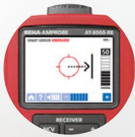
Der große Farbbildschirm zeigt Ihnen die Position und Ausrichtung spannungsführender Leitungen.
