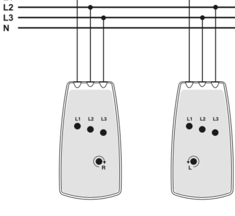
L'indicateur du sens de rotation BEHA-AM-PROBE DR 100 détecte si toutes les trois phases sont présentes et détermine la direction de la séquence des phases.
