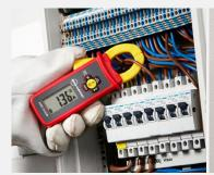
Solucione los problemas de los sistemas eléctricos y mida la corriente de carga CA/CC en los cables expuestos en un panel de disyuntores.
