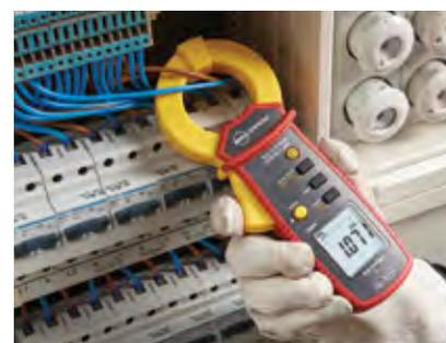
Misura di corrente differenziale con pinza amperometrica
