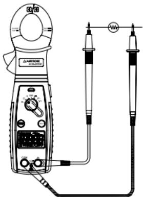
Fig. 5 Mesure de résistance
