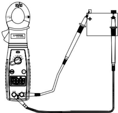
Fig. 1 Medición de tensión CC
