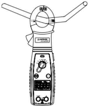
Fig. 3 Misure di corrente alternata
