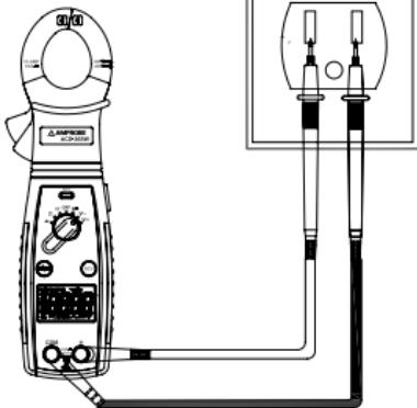
Fig. 2 Medición de tensión CA
