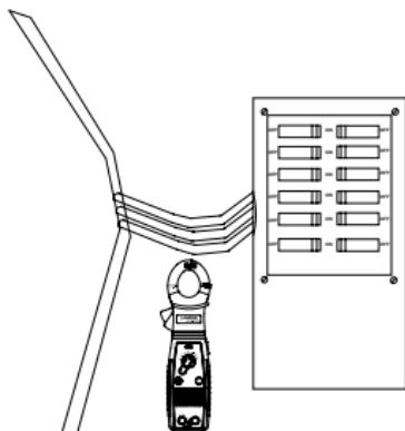
Abb. 7 Berührungslose Spannungsmessung (NCV)
