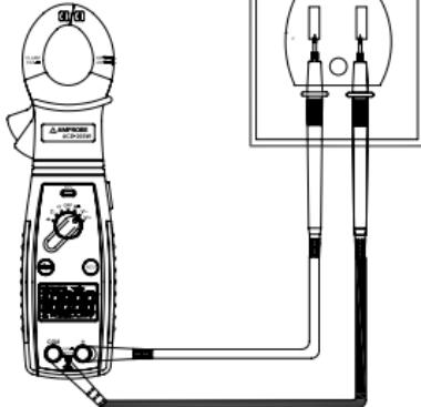
Fig. 2 Mesure de tension c.a.
