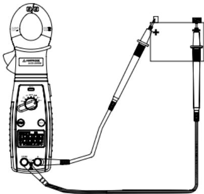
Fig. 1 Misure di tensione in corrente continua
