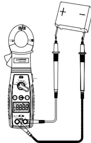
Fig. 4 Mesure de capacitance
