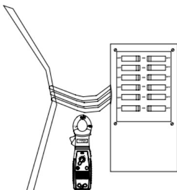
Fig. 7 Medición de tensión sin contacto (NCV)
