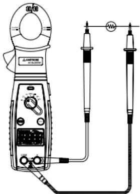
Fig. 5 Medición de resistencia
