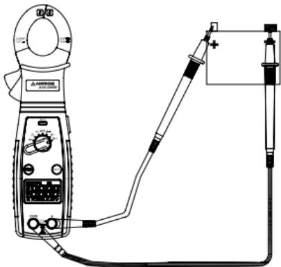
Abb. 1 Messen von Gleichspannung
