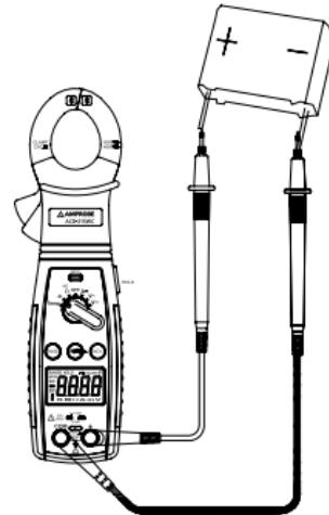
Fig. 4 Medición de capacitancia
