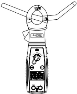
Abb. 3 Messen von Wechselstromstärke
