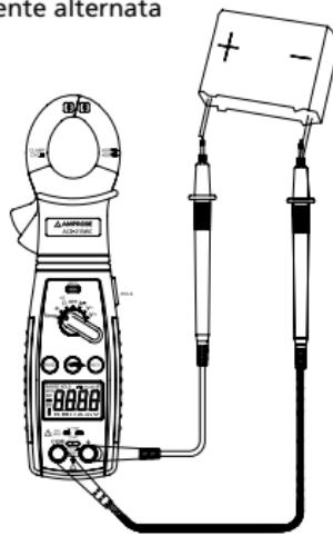
Fig. 4 Misure di capacità
