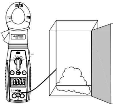
Fig. 6 Mesure de température
