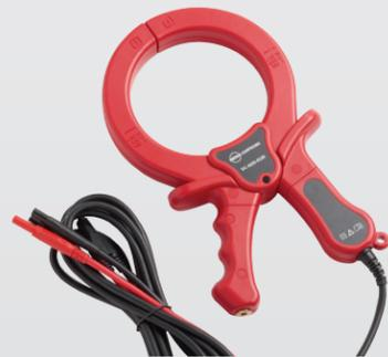
**Pince de signal SC-600-EUR** L'accessoire pince de signal fournit une méthode efficace et sûre pour appliquer un signal de localisation à un câble, permettant au transmetteur d'induire un signal à travers l'isolation dans les fils ou les tuyaux. La pince fonctionne uniquement sur les circuits fermés à faible impédance.
